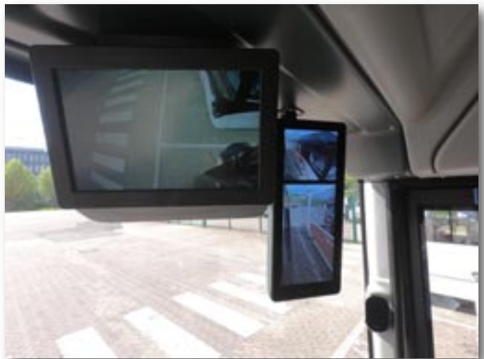
Gode spejl kameraer med markeringer for hjulaksel og bagende, samt sidekamera, som viser bussens side og forhindringer.
